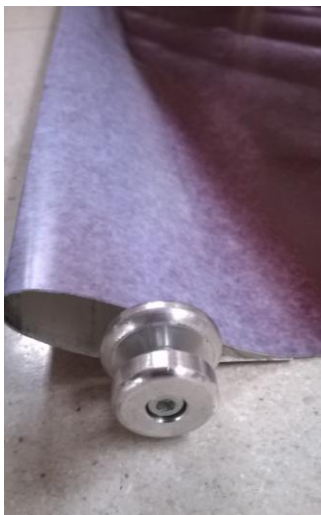
Ugao panela zavrnut šarafom na imbus.
